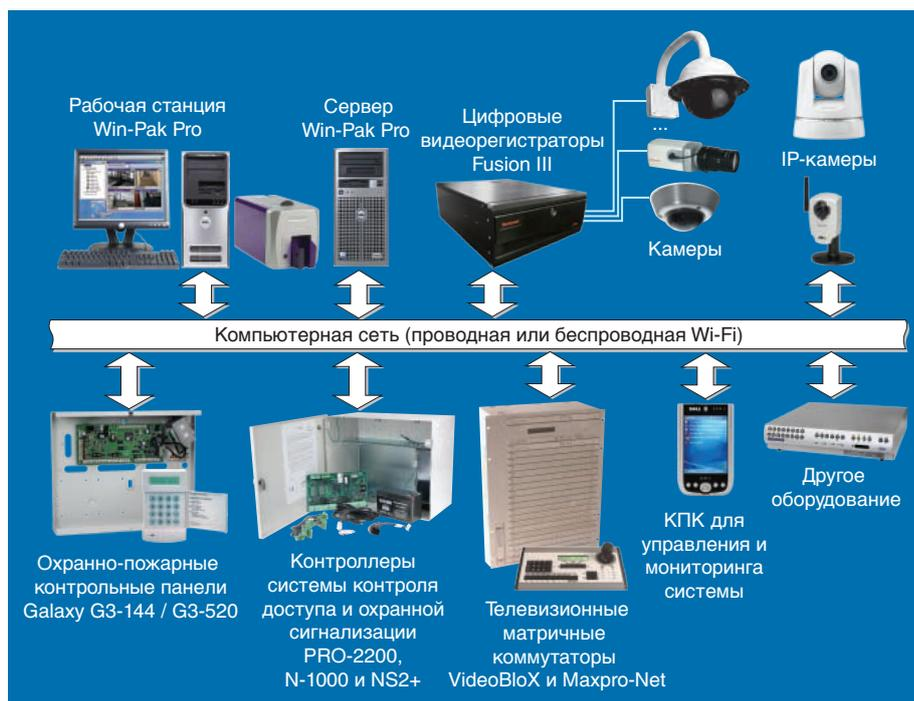
Структура комплексной системы безопасности на базе Win-Pak Pro 2005
