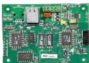
Модуль Ethernet для подключения панели по компьютерной сети с набором протоколов TCP/IP
