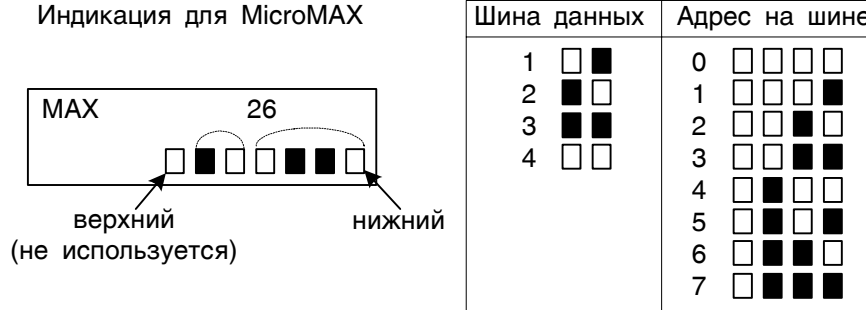
Рис. 6.1. Индикация адреса светодиодами MicroMAX.
