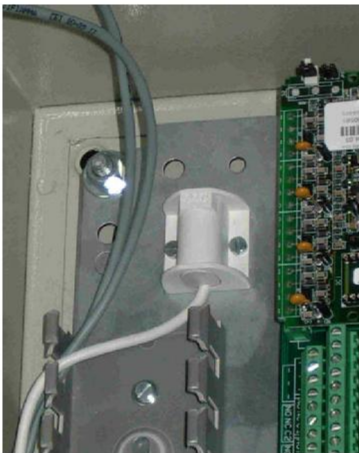
Рис. 36: Место установки датчика CSA444
