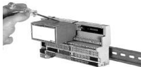
Рис. 26. Разблокировка пружинного зажима на модуле.
