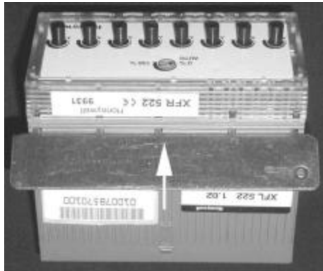
Рис. 15. Установка специального приспособления XAL2.
