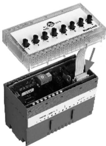
Рис. 20. Расположение гнезда для штекера модуля ручной корректировки..
