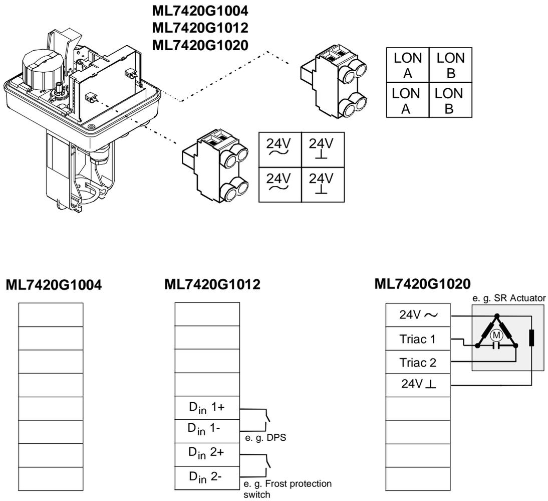
Fig. 2 Wiring
