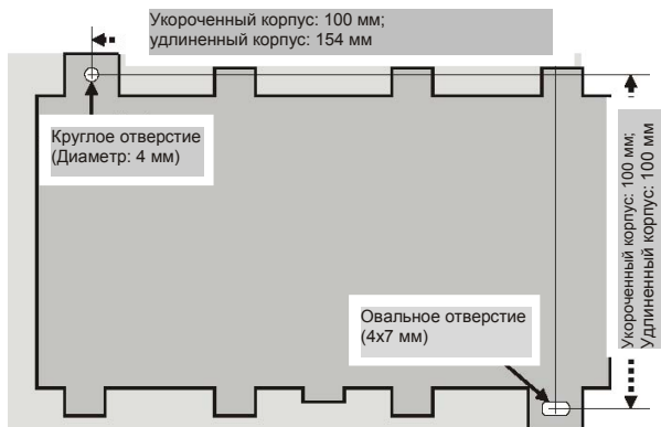
Рис. 3. Шаблон для сверления (вид сверху)
