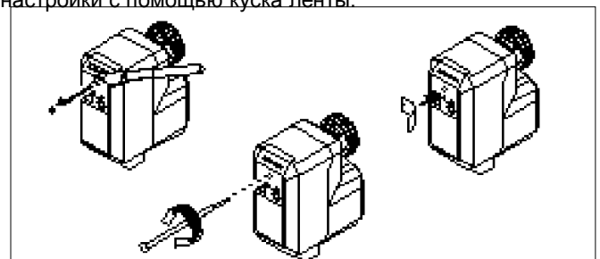
Рис.10 Регулировка вспомогательного выключателя S2
